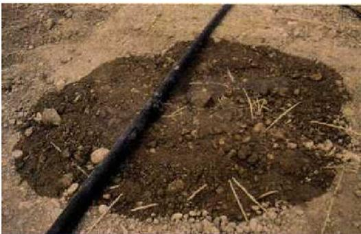
**Figura 4.** Área húmeda generada por un gotero de 24 l/h después de 4 horas de riego.
