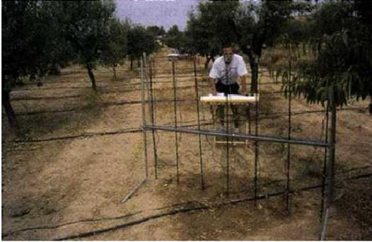
**Figura 2.** Las lecturas entre electrodos consecutivos que se van introduciendo en el suelo, permiten determinar la forma del bulbo húmedo.
