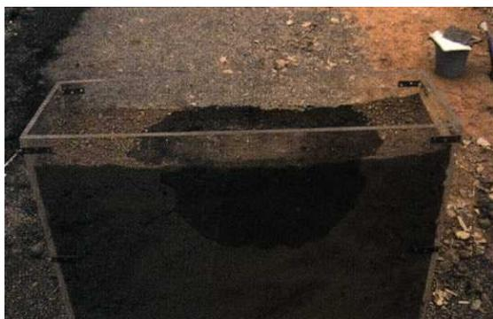
**Figura 1.** Observación de un bulbo húmedo generado en un suelo situado dentro de una caja de plástico transparente rígido.
